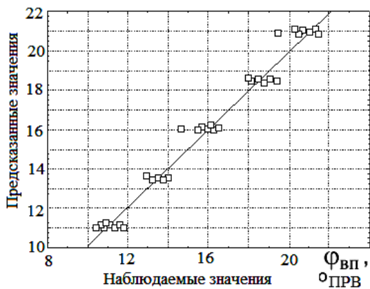
Рисунок 7 – Положение наблюдаемых значений \phi_{вп} относительно линии равных величин \phi_{вп} для нагрузочной характеристики: □ – наблюдаемые значения \phi_{вп}
