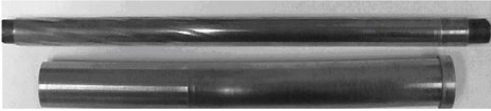
Рисунок 5 – Профильная оправка и ствол стрелкового оружия, изготовленный методом радиального обжатия
