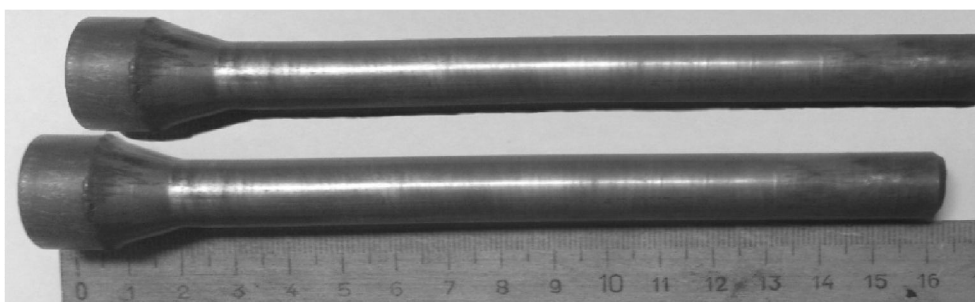
Рисунок 2 – Ствольные заготовки, полученные путём гидроэкструзии на гладкой оправке
