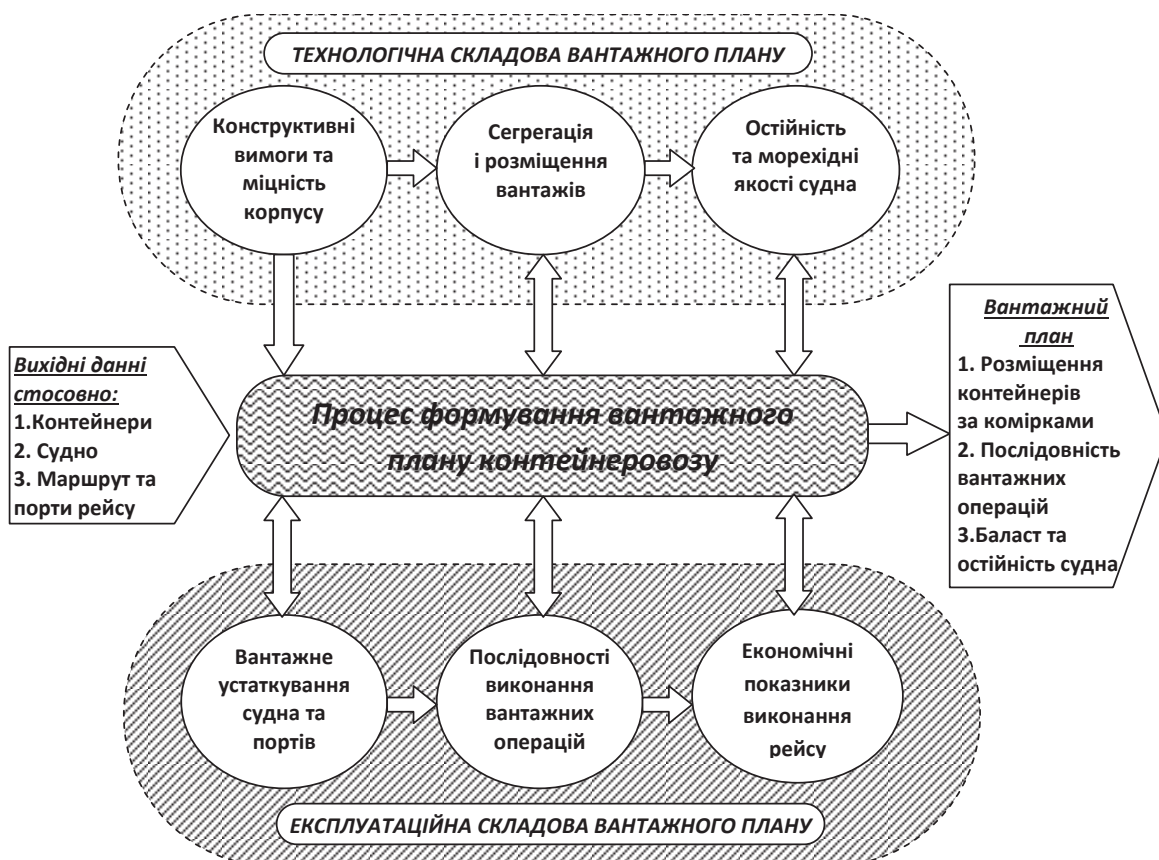
Рисунок 4 – Структура процесу формування вантажного плану контейнеровозу та взаємозв'язок основних чинників впливу на нього
