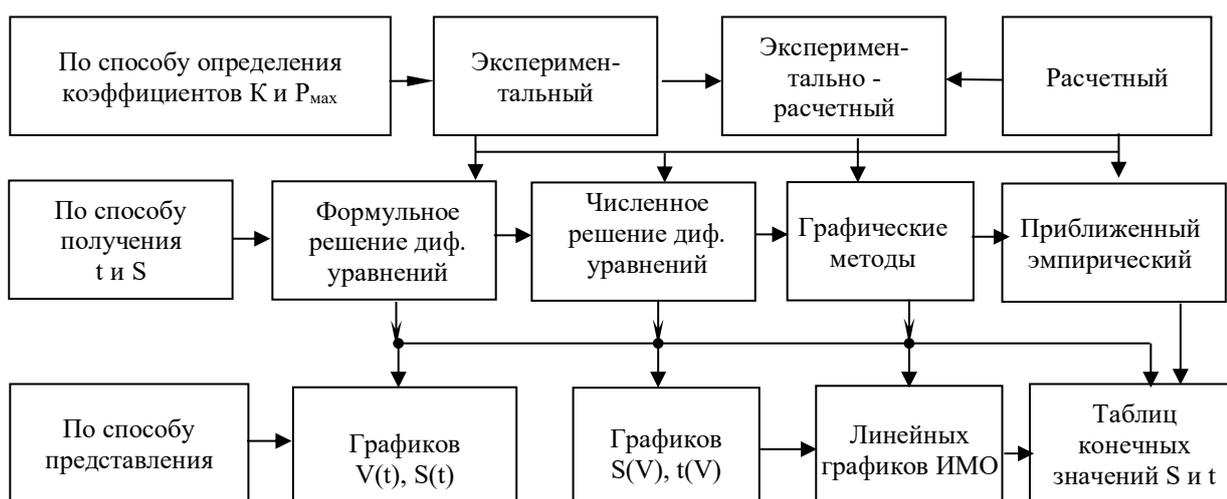
Рисунок 1 – Классификация методов определения тормозных характеристик
