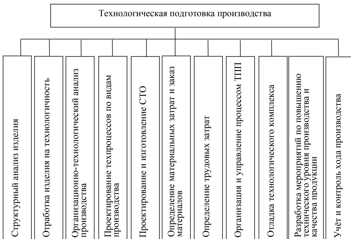
Рисунок 2 – Виды основных работ технологической подготовки производства верфи
