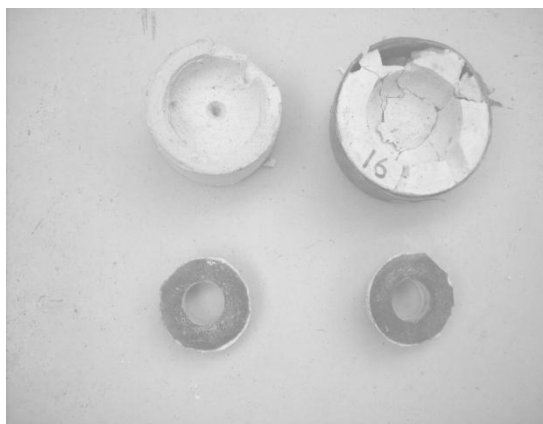
Рис. 1 – Гіпсова форма та отриманий після заливки кільцевий зразок
