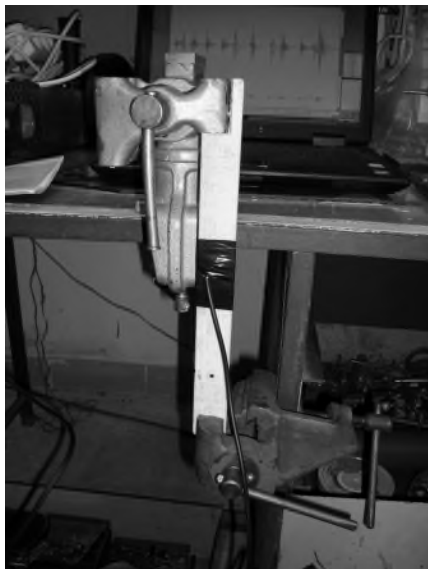
Рисунок 7 – Тарування датчика для вимірювання вібраційних коливань: а) закріплення балки під час дослідів; б) допоміжний інструмент – щуп та штангенциркуль
