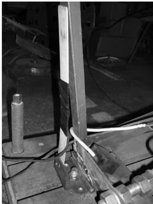
Рисунок 5 – Балка, що працює на згин під час коливального руху установки
