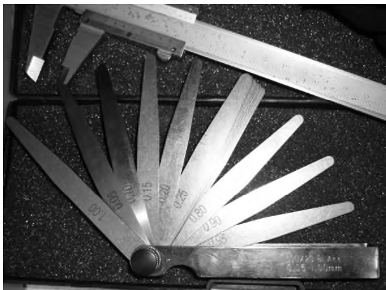
Рисунок 7 – Тарування датчика для вимірювання вібраційних коливань: а) закріплення балки під час дослідів; б) допоміжний інструмент – щуп та штангенциркуль
