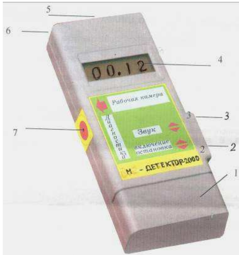
Рисунок 1 – Внешний вид аппарата и устройства управления его работой: 1 – источник питания (9 В); 2 – кнопки пуска и остановки; 3 – звуковая информация; 4 – цифровое табло; 5 – индикатор напряжения; 6 – кнопка сброса информации; 7 – рабочая камера (центр)
